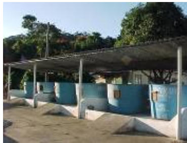
Figura 29 b – Secador híbrido trabalhando com seis câmaras de 1.000 litros.
