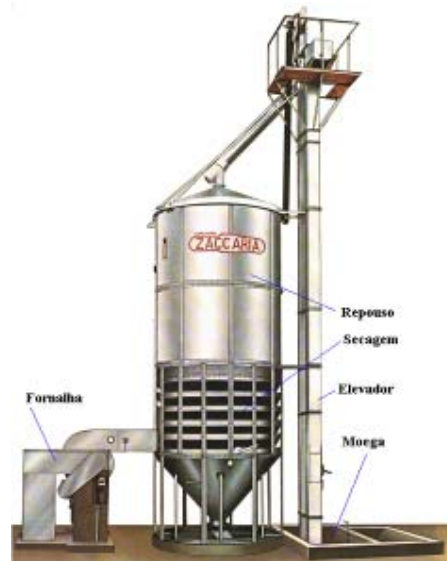
Figura 20 – Secador comercial, tipo cascata, com calhas circulares.
