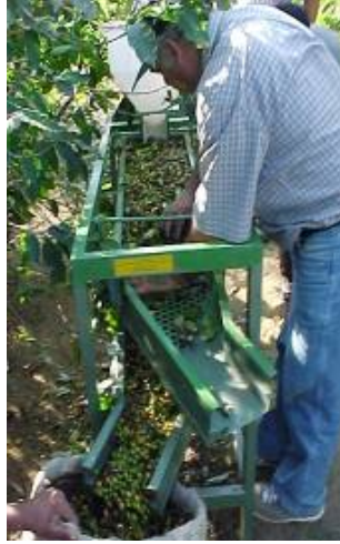
Figura 1 – Limpeza e abano com abanadora portátil com acionamento manual.
