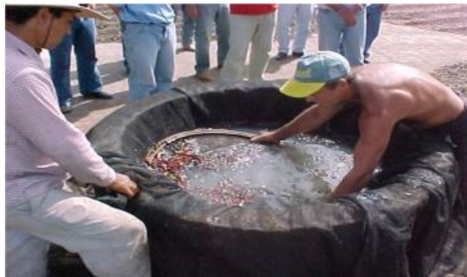
Figura 10 – Lavador rústico para café utilizando caixa-d'água e tela sombrite.
