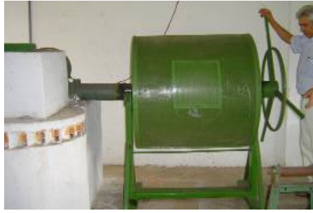
Figura 32 - Secador rotativo (rotação manual periódica) para 770 L de capacidade.
