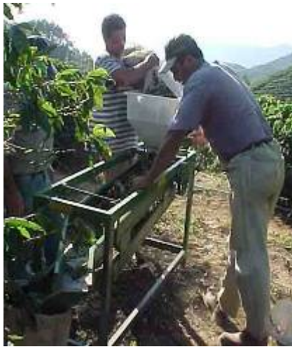
Figura 6 – Enchimento da moega e pré-limpeza em campo
