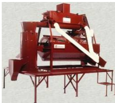
Figura 14 - Descascador de café cereja, ideal para uma associação de pequenos produtores.
