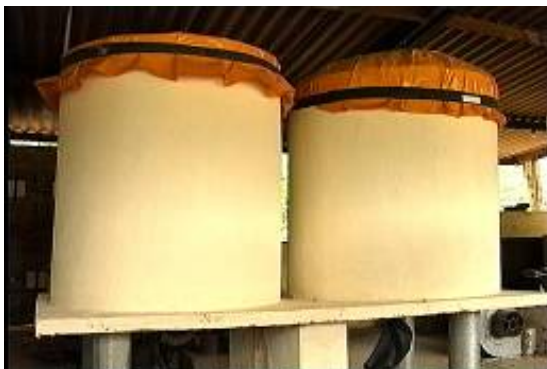
Figura 50 – Pequenos silos armazenadores, com descarga central e construída com a tecnologia ilustrada na Figura 43.
